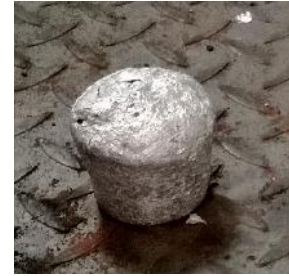
Gambar 10 Salah satu sample yang dibuat pada mesin vacuum porosity tester .
